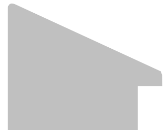
Bredde 40 mm - Høyde 33 mm Falsbredde 6 mm / høyde 12 mm
