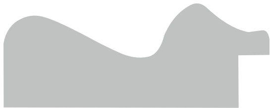
Bredde 71 mm - Høyde 28 mm Falsbredde 9 mm / høyde 14 mm
