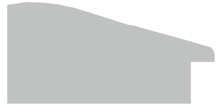
Bredde 55 mm - Høyde 27 mm Falsbredde 6 mm / høyde 11 mm
