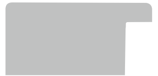
Bredde 40 mm - Høyde 20 mm Falsbredde 7 mm / høyde 16 mm
