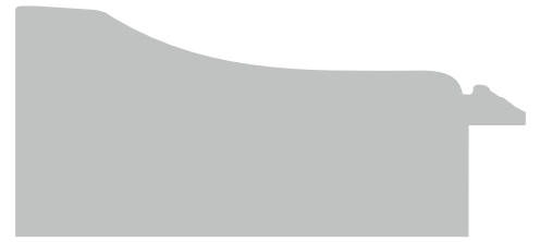
Bredde 62 mm - Høyde 28 mm Falsbredde 7 mm / høyde 14 mm
