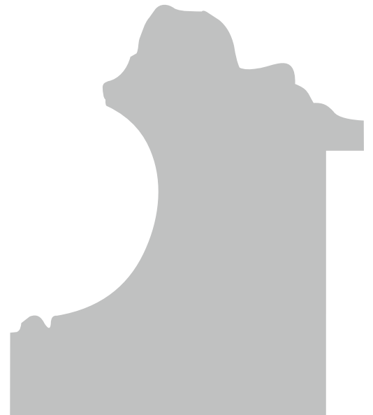
Bredde 67 mm - Høyde 78 mm Falsbredde 7 mm / høyde 50 mm
