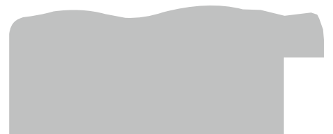
Bredde 60 mm - Høyde 25 mm Falsbredde 8 mm / høyde 15 mm
