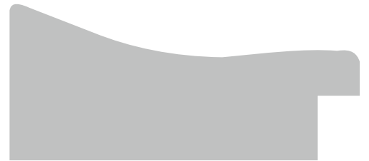
Bredde 65 mm - Høyde 29 mm Falsbredde 8 mm / høyde 12 mm
