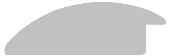
Bredde 70 mm - Høyde 23 mm Falsbredde 9 mm / høyde 13 mm
