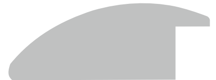
Bredde 55 mm - Høyde 21 mm Falsbredde 9 mm / høyde 14 mm
