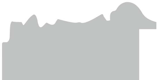
Bredde 71 mm - Høyde 36 mm Falsbredde 8 mm / høyde 23 mm
