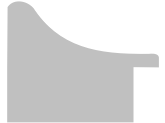
Bredde 40 mm - Høyde 32 mm Falsbredde 7 mm / høyde 15 mm
