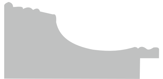
Bredde 68 mm - Høyde 34 mm Falsbredde 8 mm / høyde 9 mm
