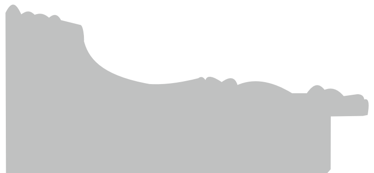
Bredde 99 mm - Høyde 46 mm Falsbredde 10 mm / høyde 16 mm
