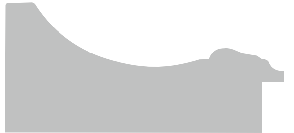
Bredde 75 mm - Høyde 35 mm Falsbredde 7 mm / høyde 13 mm
