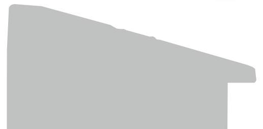
Bredde 65 mm - Høyde 33 mm Falsbredde 8 mm / høyde 13 mm
