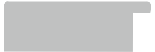
Bredde 64 mm - Høyde 22 mm Falsbredde 8 mm / høyde 16 mm
