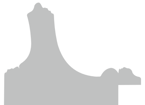
Bredde 60 mm - Høyde 45 mm Falsbredde 11 mm / høyde 9 mm
