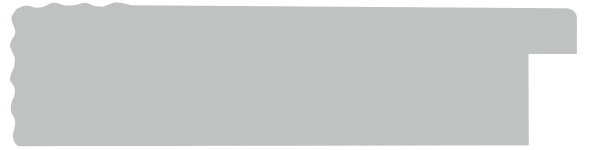
Bredde 75 mm - Høyde 19 mm Falsbredde 6 mm / høyde 12 mm
