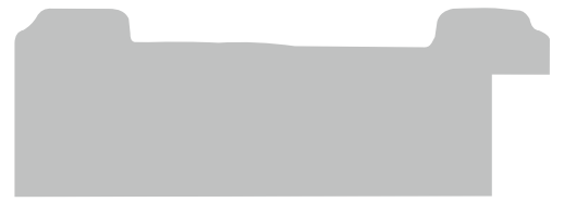
Bredde 65 mm - Høyde 23 mm Falsbredde 7 mm / høyde 15 mm
