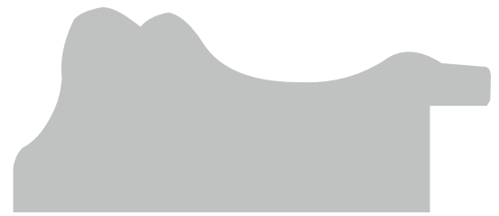
Bredde 70 mm - Høyde 30 mm Falsbredde 9 mm / høyde 15 mm
